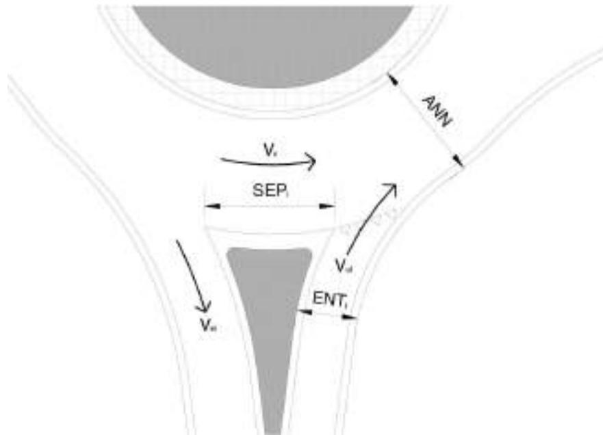
Figura 11. Caratteristiche geometriche e di traffico di un braccio di rotatoria.
